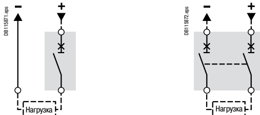
Выбор 1: стационарный 1-полюсный аппарат Compact NSX160N DC
