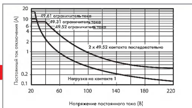
H 49 - Макс. отключающая способность DC1 Типы 49.31/52/61/72/81
